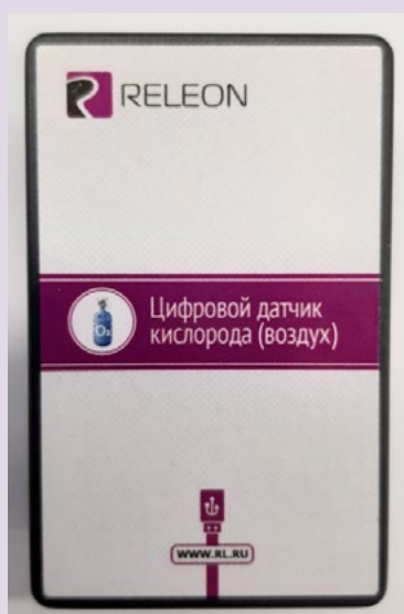
Рис. 11. Датчики кислорода (слева) и угарного газа (справа)
