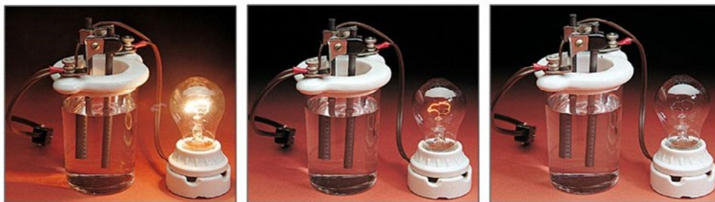
Рис. 23. Приборы для измерения электропроводности веществ
